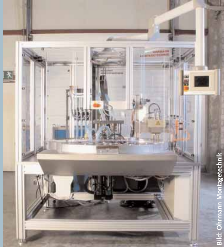
Bild 5: Einzelne Stationen können in Rundtischanlagen oder Transferstraßen in ein vorhandenes oder in ein neu zu erstellendes Systemumfeld integriert werden.
